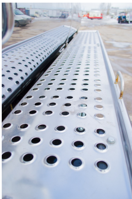
Площадка обслуживания с перфорированной противоскользящей поверхностью
