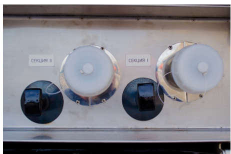
Выходы сливного трубопровода ДУ50 с молочной резьбой Rd-78, закрыты пластиковыми крышками. Рычаги управления донными клапанами
